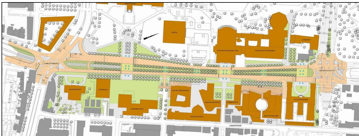
Mögliche Oberflächengestaltung bei Bau eines durchgehenden Tunnels zwischen Charlottenplatz und Gebhard-Müller-Platz (aus der Machbarkeitsuntersuchung Oktober 2000)
